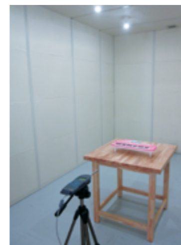
■音響玩具の音圧測定風景
