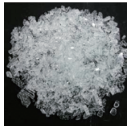
■写真4: なべ蓋の破損破片
