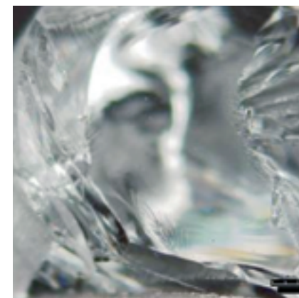
■写真5: 端面不良破壊の始発点
