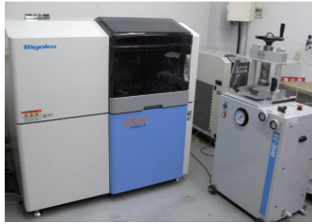
■写真左は蛍光X線分析装置、右前は測定試料の作成装置
