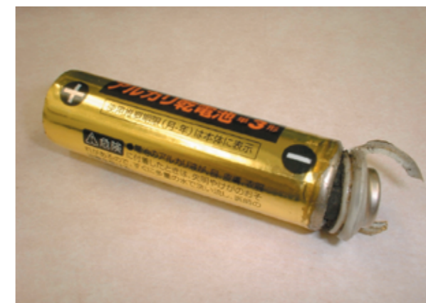
■誤装填により破裂したアルカリ乾電池
